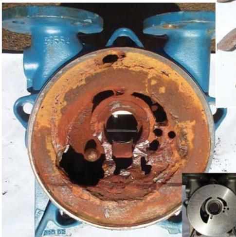
ingrandiscono formando delle bolle, che si sviluppano all'interno della vena liquida, per poi sparire (i gas o i vapori, infatti, si condensano ritornando allo stato liquido) all'impatto con le superfici metalliche della pompa, soprattutto dove la vena incontra le palette della girante e al di sotto di queste
